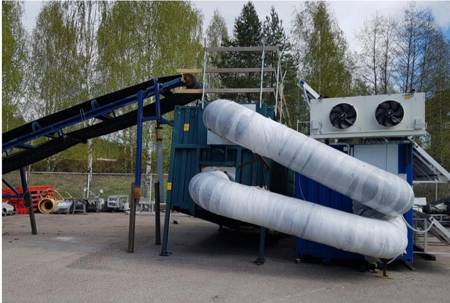
Vista lateral de dos contenedores: Dcha: contenedor con colectores y bomba de calor; Izda: contenedor con secadero de biomasa
