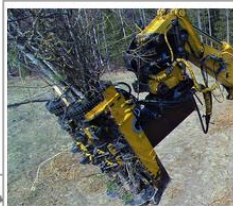
Risupeto – cabezal forestal para la recogida eficaz de madera de pequeño diámetro para biomasa
