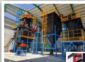
Integración de la gasificación de orujo grueso seco en almazara
