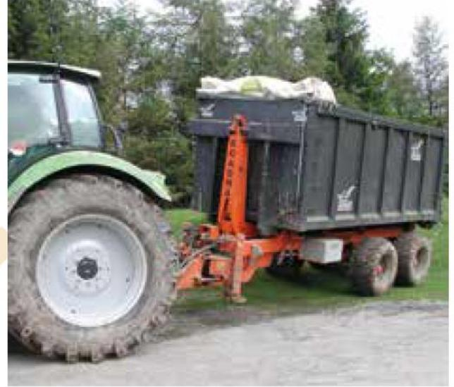
Astilado con astilladora conectada a tractor, y remolque con tamiz para evitar entrada de fracciones gruesas
