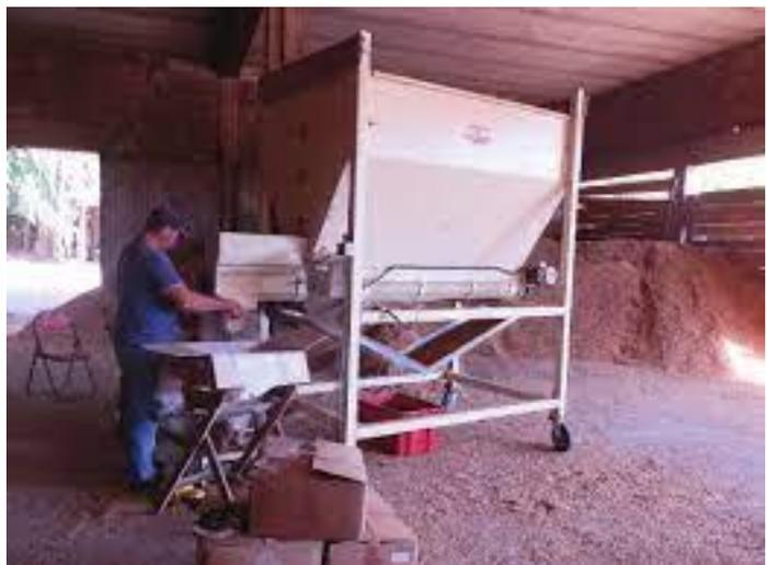
Sistemas de producción. Pala cargadora para astilla y criba para limpieza y afino de la microastilla.
