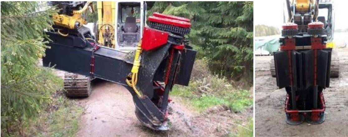
Cabezal RISUPETO montado en brazo de excavadora (ReFormet Oy)
