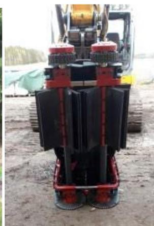
Cabezal RISUPETO montado en brazo de excavadora
