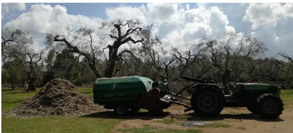
Figura 10. Una FACMA TR200 y un montón de triturado de poda de olivo. Fuente: CERTH.
