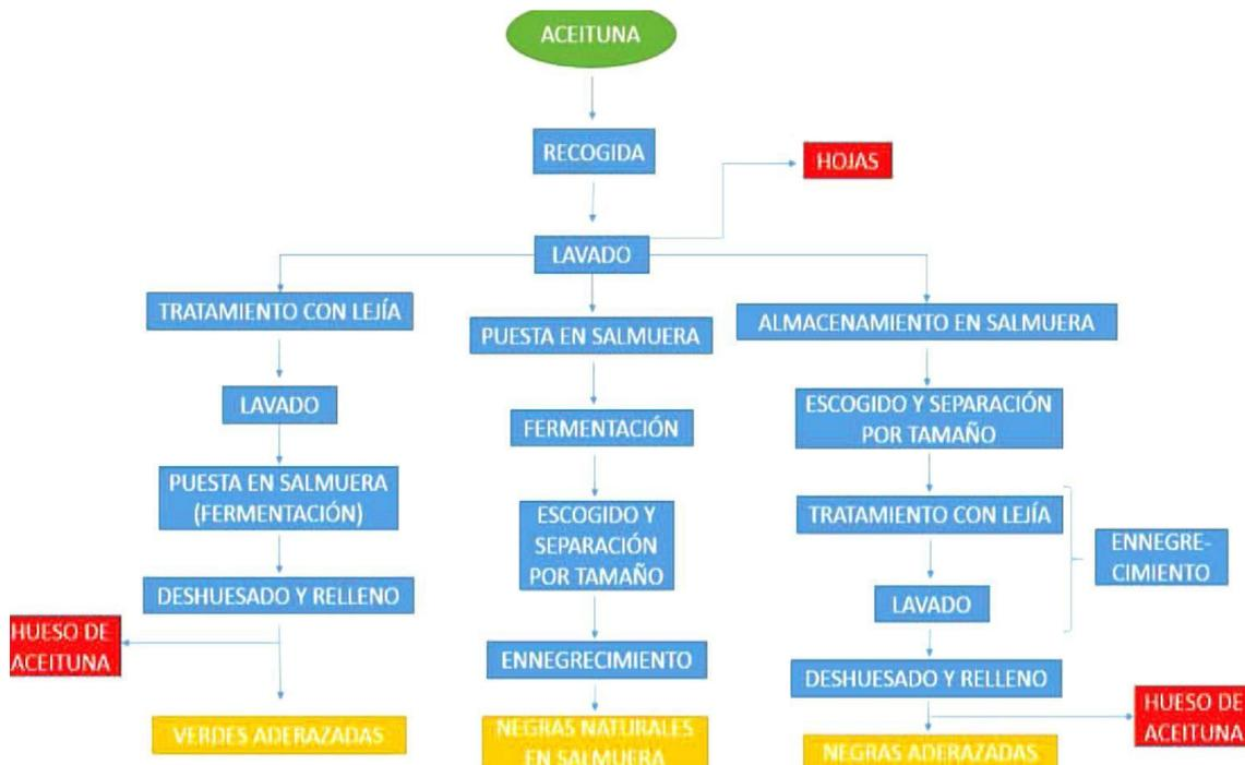
**Figura 10. Esquema del proceso de obtención de las aceitunas de mesa y subproductos generados.**
