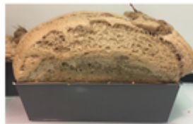
Espuma de poliuretano sintetizada a partir de serrín de pino
